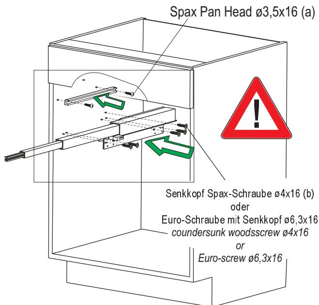
Maße für den Einbau unter einem Schubkasten
